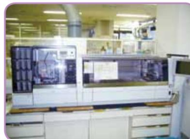
自動染色装置・自動ガラス封入装置連結タイプ（サクラ精機 Tissue-Tek）
